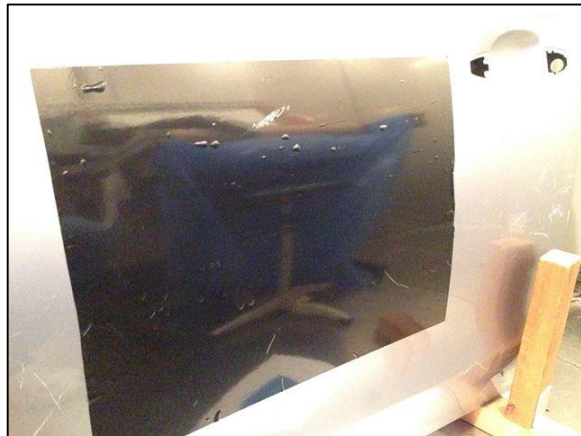
写真4: 加圧不足によるエア噛み例
