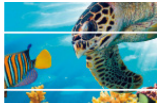
隙間 / 白すじ (フィード量過多)
