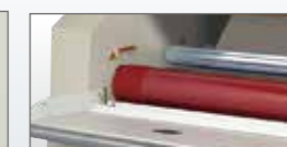
▲高品質シリコンヒートローラーの採用
